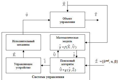
Рис. 5. Структурная схема системы управления по возмущению
